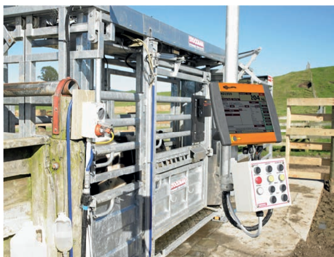
Le TSi 2 pèse le bétail et collecte des données garantissant une gestion optimale du cheptel
