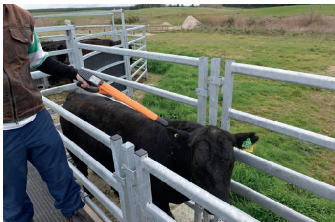
Le HR5 lit la marque d'identification de l'animal et affiche clairement l'identité visuelle sur l'écran.
